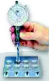
**MESURE DIAMÈTRE DANS ALÉSAGE CONIQUE**
